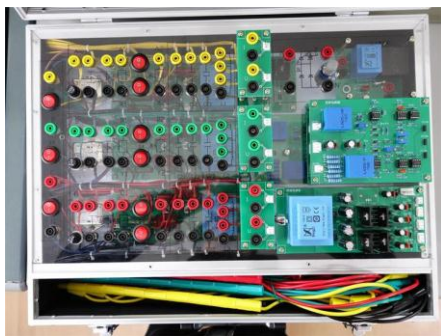
船舶三相功率理论实验装置
